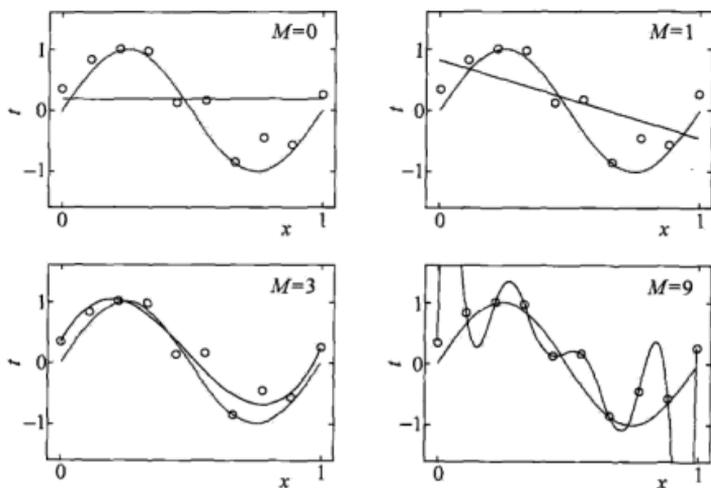
图 1.2  $M$  次多项式函数拟合问题的例子
