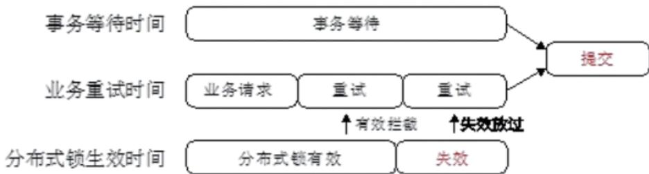
图 4-3 分布式锁超时并发控制时间轴
