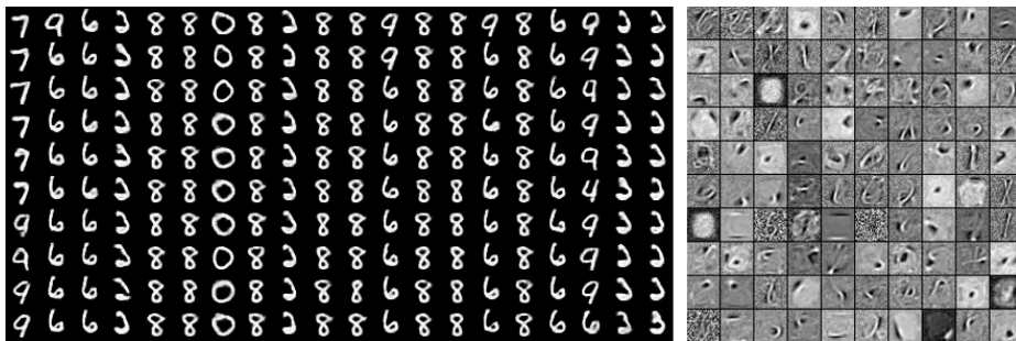
图 16.15: 训练好的 RBM 的样本及其权重。(左) 用 MNIST 训练模型, 然后用 Gibbs 采样进行采样。每一列是一个单独的 Gibbs 采样过程。每一行表示另一个 1000 步后 Gibbs 采样的输出。连续的样本之间彼此高度相关。(右) 对应的权重向量。将本图结果与图13.2中描述的线性因子模型的样本和权重相比。由于 RBM 的先验 p(\mathbf{h}) 没有限制为因子, 这里的样本表现得很好。采样时 RBM 能够学习到哪些特征需要一起出现。另一方面说, RBM 后验 p(\mathbf{h} | \mathbf{v}) 是因子的, 而稀疏编码的后验并不是, 所以在特征提取上稀疏编码模型表现得更好。其他的模型可以使用非因子的 p(\mathbf{h}) 和非因子的 p(\mathbf{h} | \mathbf{h}) 。图片经 LISA (2008) 允许转载。
