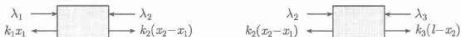
图 5.9 模块-弹簧系统的受力分析。每个模块受弹簧力及相互之间的接触力, 总受力应该为零。Lagrange 乘子标在上方, 可以理解为墙和模块之间, 模块之间的接触力。弹簧力标在下面。
